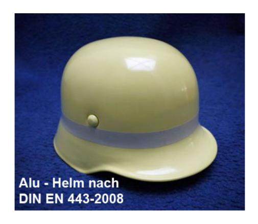
Helmschale aus Aluminium. Hitze- und isolationsbeständig nach EN 443. Innenliegendes Kopfpolster aus PUR-Hartschaum, und Innenausstattung aus Stahlband, Filz, Schweißleder und Polyesterbebänderung, vierteiliger Kinn-Nacken-Riemen aus doubliertem Leder mit Klemmschnallenverschluß, weißes Reflexband RAL 9019, 20 mm breit.
